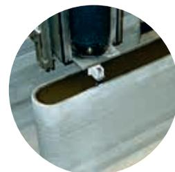
Die computer-gesteuerten Arme spritzen den Beton Schicht für Schicht auf.
